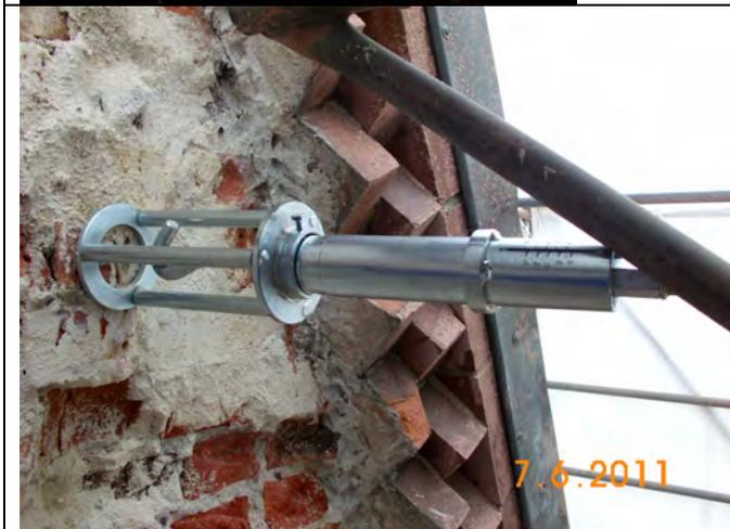
Prüfgerät für Gerüstanker.
