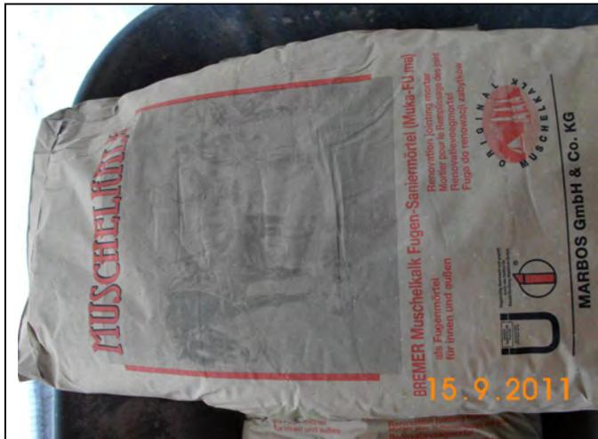
Fugensaniermörtel zur maschinellen Verarbeitung
